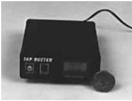
Joonis 98. Telefoniliinide seire: a - lihtne detektor harundite ja raadiosageduste tuvastuseks liinil, b - reflektomeetriline analüüs ütleb, et 150 m kaugusel on salaharund
