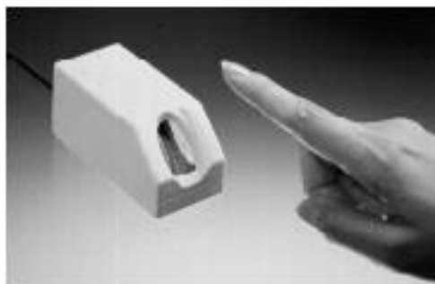
Joonis 42. PC järjestikpordiga ühendatav sõrmejäljeskanner
