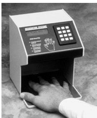
Joonis 43. Kontrollkellaga integreeritud käelabaskanner
