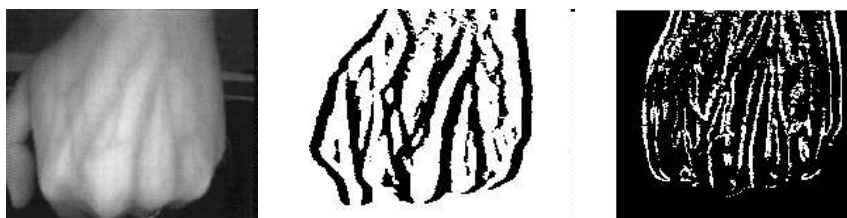
Joonis 44. Käeveenide skaneerimine: täielik kujutis, kontrastpilt, XOR-võrdlus
