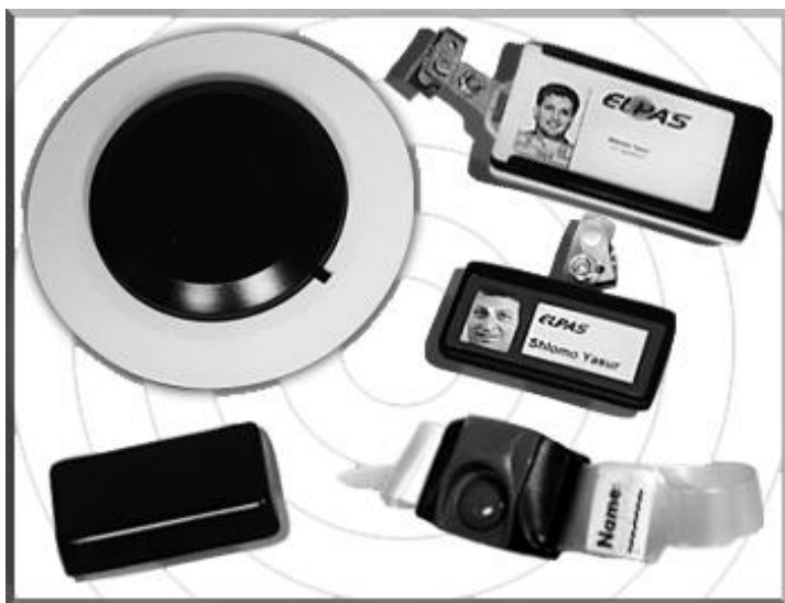
Joonis 26. Infrapuna-autentimine. Vasakul vastuvõtja, paremal ID-kaardiga IP-rinnasilt, personali IP-rinnasilt ja patsiendi randmesilt
