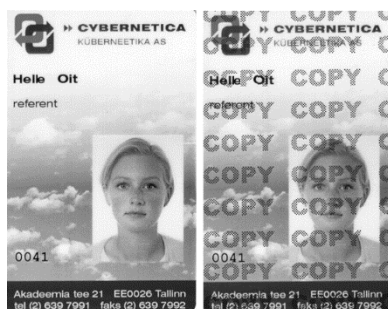
Joonis 20. Kopeerimisel või skaneerimisel tekkiv sõrmejälgetekst
